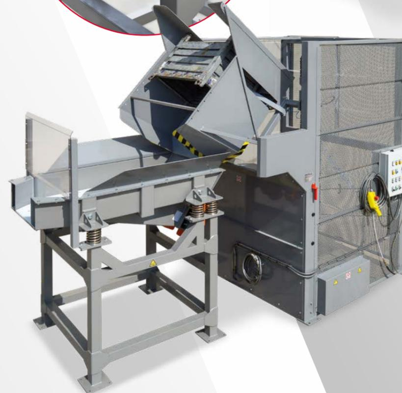
Il vibrovaglio, quando viene versato il materiale irrorato di acqua, mediante il fondo forato, permette la permeabilità e il convoglio dell'acqua nel piano inferiore munito di tubo di scarico.
