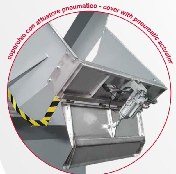
*coperchio con attuatore pneumatico - cover with pneumatic actuator*
