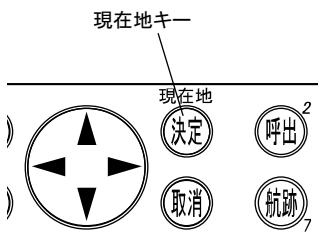
通常は自船位置が中心に表示されていますが、方向キーを押すと地図の中心に十字のカーソルが表示され、地図が移動します。
