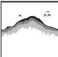
画像が薄れて魚群の判別がしにくくなり小さな魚群の反応が消えてしまいます。また深度表示が正常に動作しなくなる恐れがあります。
