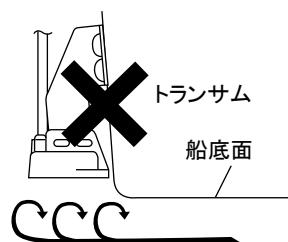
船尾の船底より上に取り付けると気泡を巻きやすくなり、ボートのスピードを上げると映らなくなります
