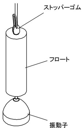
1. フロートの位置を調整して、ゴムストッパーをフロートにはさみます。
