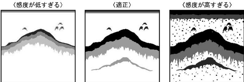
画像が薄れて魚群の判別がしにくくなり小さな魚群の反応が消えてしまいます。また深度表示が正常に動作しなくなる恐れがあります。
