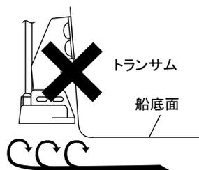
船尾の船底より上に取付けると気泡を巻きやすくなり、ボートのスピードを上げると映らなくなります
