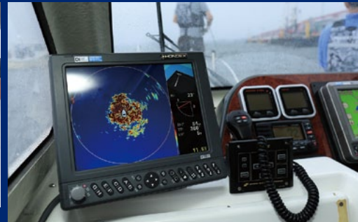
魚探よりも広い範囲を探索できるデジタルマルチスキャン HE-773 II-Di。ビームの角度を変えて、水面直下から底まで探ることができる
