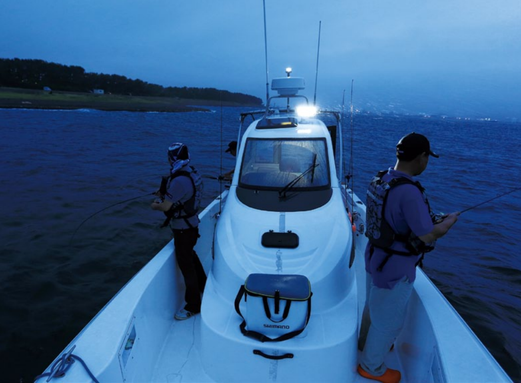
ポイントを移動しているうちに日が暮れた。LEDサーチライトのHRL-2070G/Uは、障害物の位置などを確認するのに役立つが、航海灯以外の灯火は必要とときだけ照射すること
