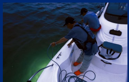
写真は三信船舶電具の水中投下タイプの集魚灯。なお、集魚灯は海域によって使用が制限されているところもある
