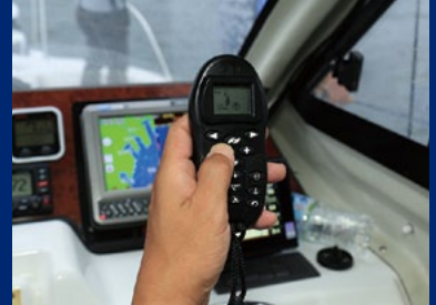
これがアイパイロットのリモコン。バックライト付きなので、夜間でも問題なく使える
