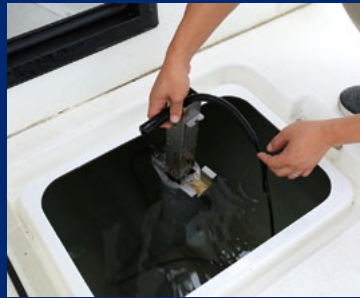
HE-773 II-Diの振動子は昇降式。〈アベニール〉にはイケス内に取り付け可能な、手動式の折れ曲がりタイプがセットされていた。自動昇降式もある
