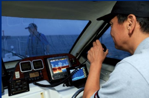
夜間は周りにフネが少なかったり、マリーナの営業時間外だったりすることも考えられる。大型船や海上保安庁などと交信できる国際VHF無線機、GX2150Jは、心強い連絡手段だ
