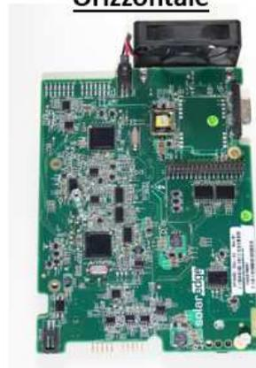
5. Reinstallare la nuova scheda Digitale verificando che i connettori siano correttamente inseriti
