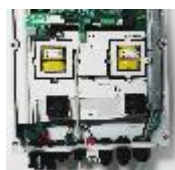
RS485-1 Côté onduleur StorEdge
