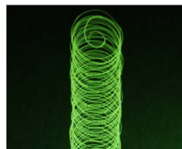
Precisione dei bordi della spirale di colla a caldo
