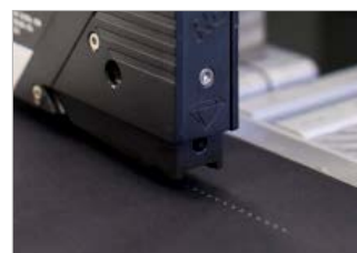
Applicazione hotmelt a punti o a cordoli
