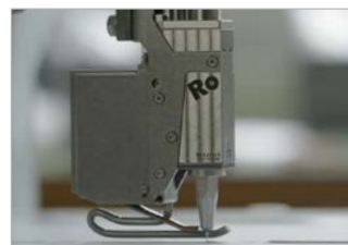
Application de colle froide
