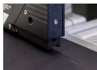
Aplicación de cola caliente en forma de puntos o cordón
