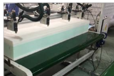
Application par pulvérisation sur mousse
