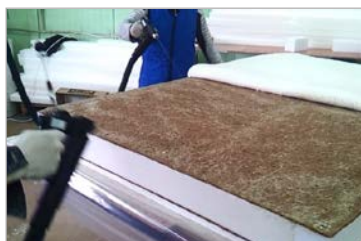
Application par pulvérisation manuelle
