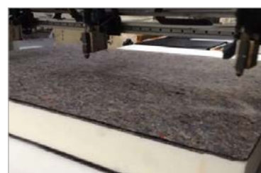
Application par pulvérisation sur du non-tissé
