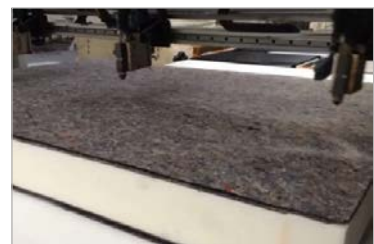
Sprühauftrag auf Vlies
