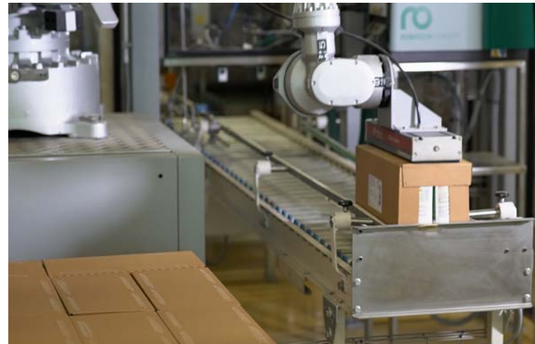
İkincil ambalajların tutkal uygulaması ile paletlenmesi
