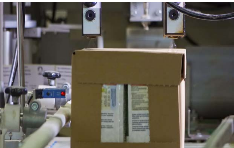
Dos cabezales de pulverización del tipo AX Diamond durante la aplicación de adhesivo
