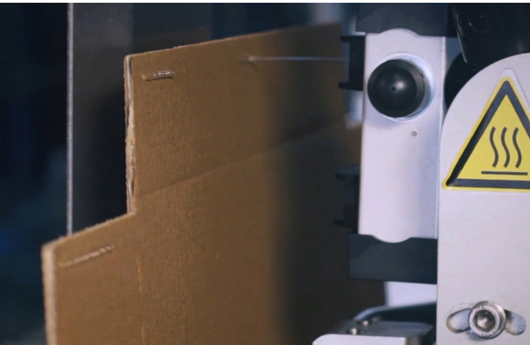
SX LongLife ile kapak kulağında aralıklı tirtil uygulaması
