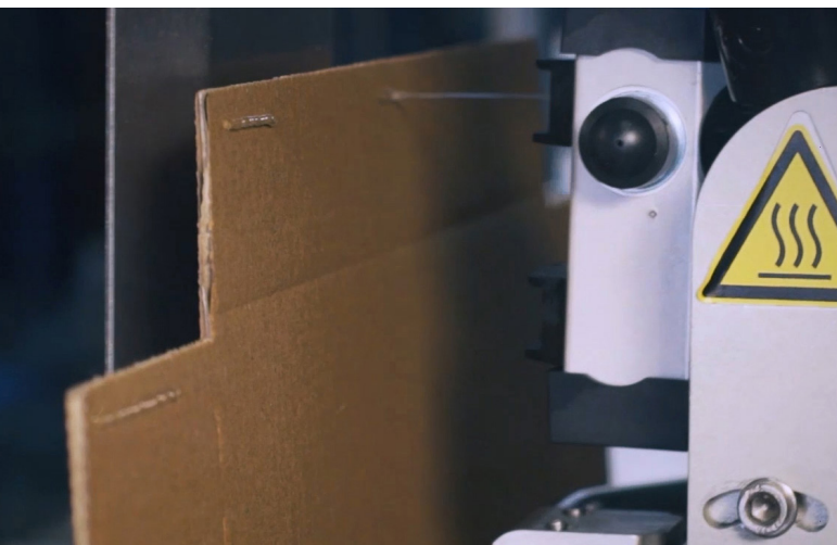
Applicazione a cordoli a intermittenza sulle linguette del coperchio con SX LongLife
