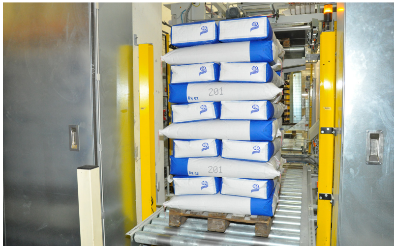
Gotowa paleta z załadowanymi workami opuszcza system paletyzacji
