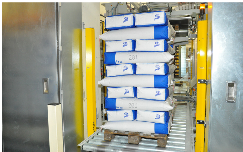
La pila pallettizzata esce dall'impianto di pallettizzazione
