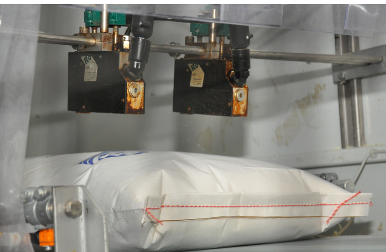
Due pistole spray AX-Diamond applicano spirali di colla a caldo senza contatto
