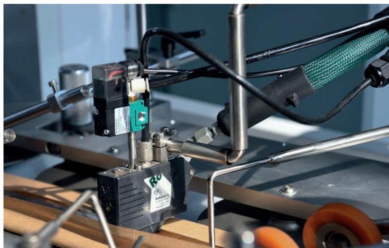
Tête d'injection AX Diamond pour la seconde application de colle chaude sous forme de cordons
