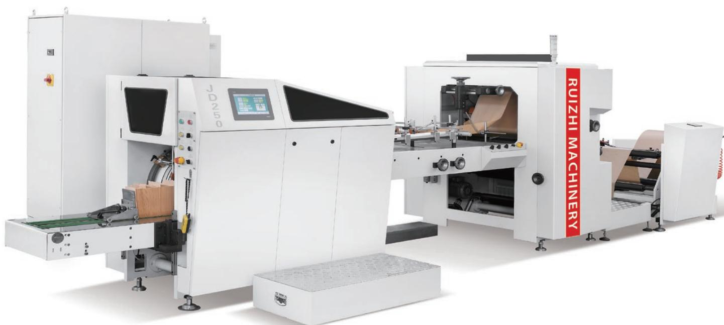
Machine de fabrication de sachets en papier à fenêtre
