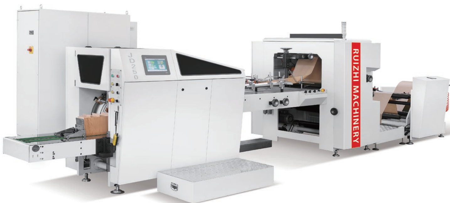
生产带有观察窗的纸质包装袋的机械设备
