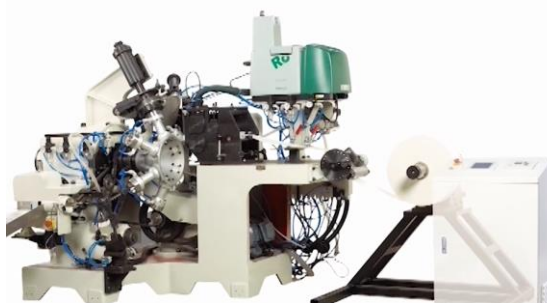
Maszyna do produkcji rożków firmy Dayuan z topielnikiem Concept oraz głowicą AX Diamond firmy Robatech
