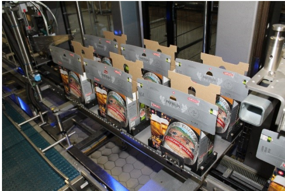
真直ぐに立てた段ボール箱、最初の接着後の状態
