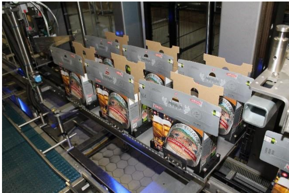
Aufgerichtete Kartonagen nach der ersten Verklebung
