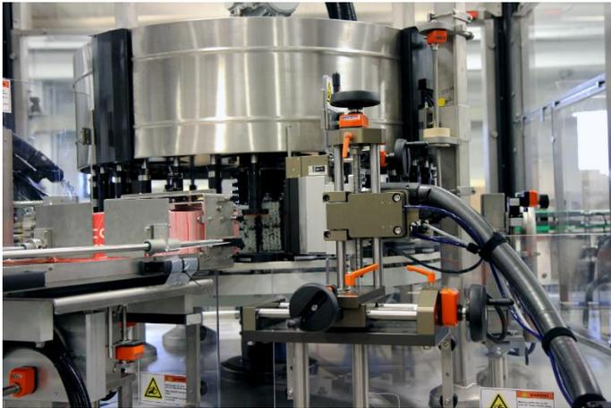
diminuta de adhesivo directamente a la lata. Portado el punto de adhesivo con forma de espiral, la lata continúa girando alrededor de su propio eje sobre la bandeja, orientándose correctamente para recoger una etiqueta de la bandeja de etiquetas precortadas cuando pasa junto a ella. Mientras continúa girando sobre la cinta transportadora, la lata se envuelve a sí misma en la etiqueta precortada, extrayéndola de la bandeja.
