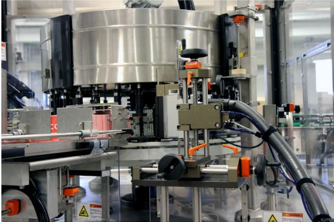
Karussell weiter und um die eigene Achse, bis sie richtig ausgerichtet ist und mit dem aufgesprühten Klebstoff eine geschnittene Etikette aus einem Magazin aufnimmt. Die sich drehende Dose wickelt die Etikette dann automatisch um sich und zieht sie dabei aus dem Magazin. Kurz bevor die Etikette durch die Rotation der Dose ganz aus dem Magazin herausgezogen wird, trägt ein zweiter Heissleim-Auftragskopf einen
