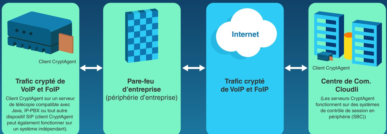
Le CryptAgent est composé d'un client fonctionnant sur tout système compatible avec Java derrière le pare-feu de l'entreprise et d'une application serveur fonctionnant sur les éléments SBC des centres de communication Cloudli.
