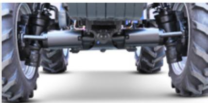
L'essieu du moteur avant bénéficie du meilleur design et est disponible sur tous les produits de la série TB. Le boîtier est formé de manière intégrée, de sorte que sa capacité de charger est plus forte et que la traînée et la traction sont faciles à réaliser. Le boîtier est également adapté à des machines et des outils frontaux tels qu'un chargeur frontal. La structure d'entraînement à engrenages à double biseau est dotée d'une étanchéité élevée et offre
