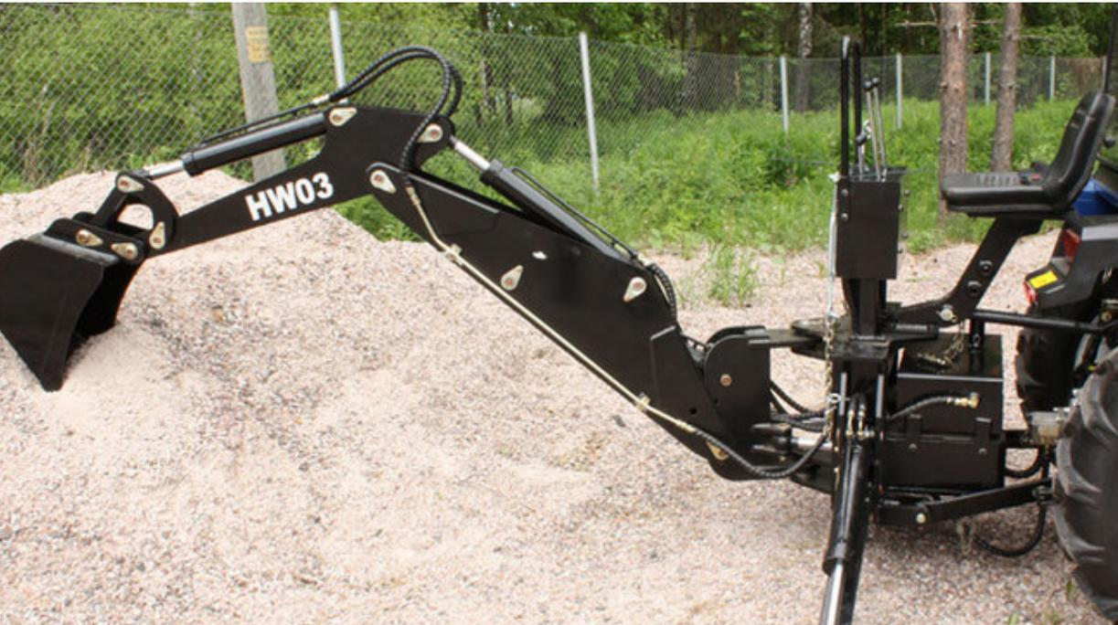
La pelle rétrocaveuse (HW03 pour le modèle TE et HW05 pour le modèle TB) a été conçue pour fonctionner parfaitement avec les modèles de tracteurs LOVOL. Grâce à son joint de changement rapide, une personne peut l'installer ou la détacher en moins de cinq minutes! Différentes options de sorties hydrauliques sont disponibles. ① Sortie hydraulique double boucle + sortie hydraulique simple boucle. ② Sortie hydraulique à boucle unique (standard).
