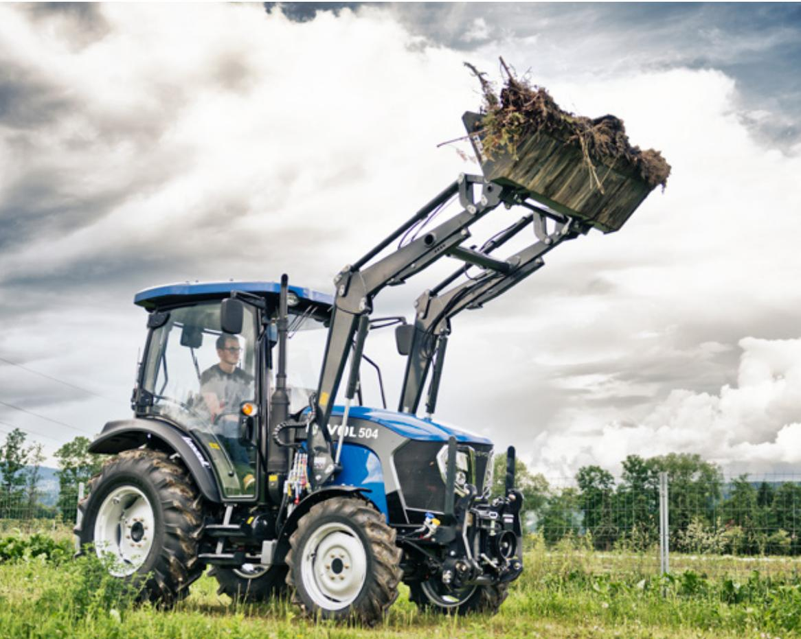
Le chargeur frontal est conçu en fonction de la structure du tracteur et la puissance du moteur. Lors du travail, le chargeur frontal n'interfère pas avec le capot du tracteur, les pneus et les autres composantes. L'équipement est installé le plus près possible de l'axe longitudinal du tracteur afin que le poids du chargeur frontal et les matériaux soient répartis uniformément sur les essieux avant et arrière. La capacité portante du tracteur est améliorée.
