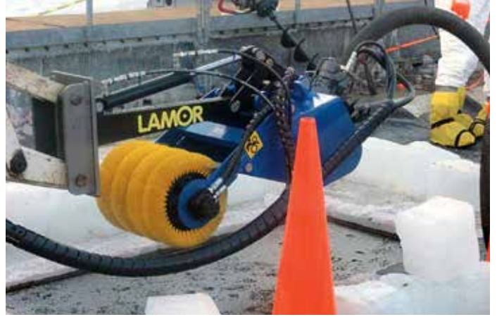
Lamor Toplama Kovası 40 (LRB 40), kapasite: 19 \text{ m}^3/\text{s} (83 galon/dakika)
