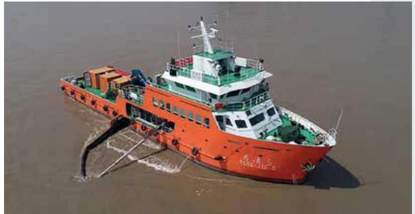
Yerleşik Petrol Toplama Sistemi (LORS)
