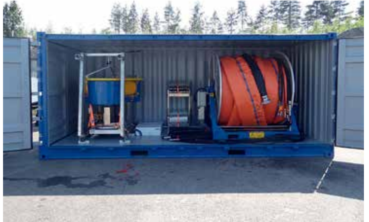
Konteynerli bir sistemin parçası olarak Hortumlu Tambur
