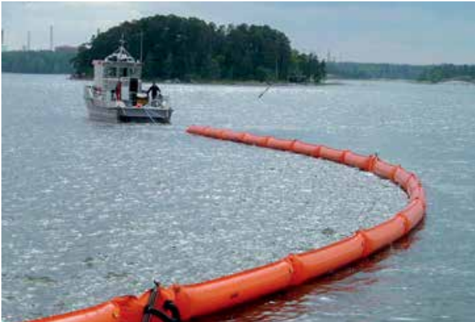
AutoBoom (PU ve Neopren), yükseklik: PU 550-1820 mm (22-60 inç), Neopren 970-2000 mm (38-79 inç)
