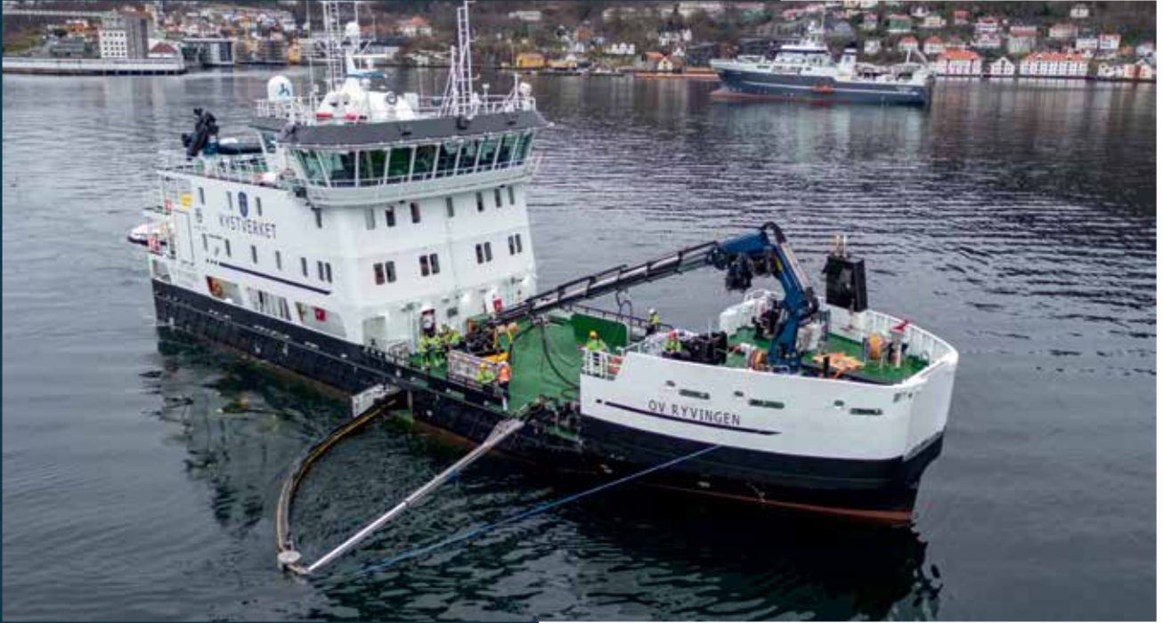
Yerleşik Petrol Toplama Sistemi (LORS)
