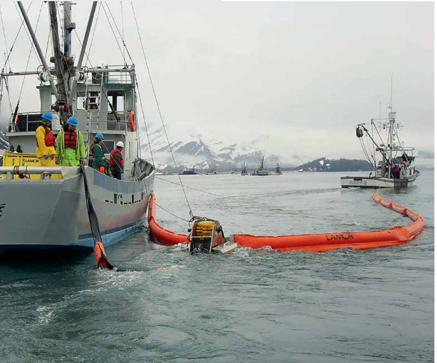
Multimax 50 (LAM 50), kapasite: 50 m 3 /s (220 galon/dakika)
