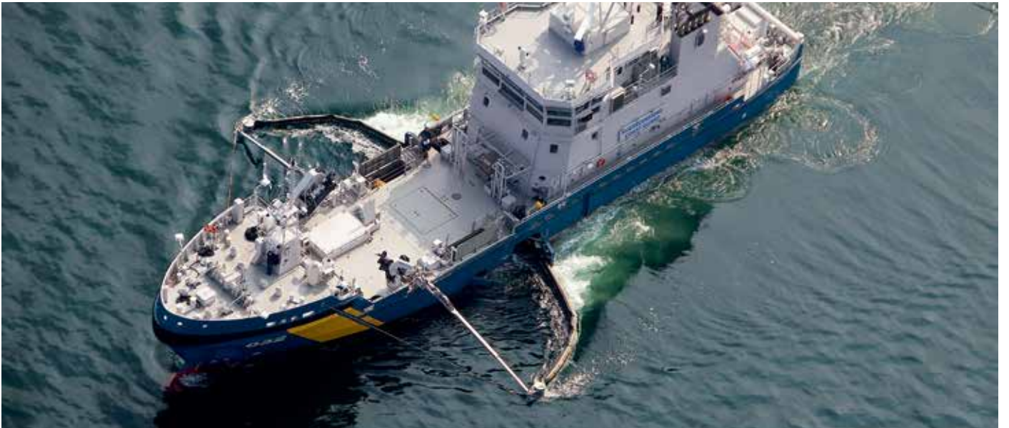
Yerleşik Petrol Toplama Sistemi (LORS)
