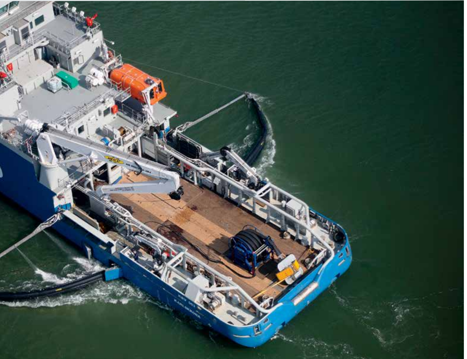
Yerleşik Petrol Toplama Sistemi (LORS)
