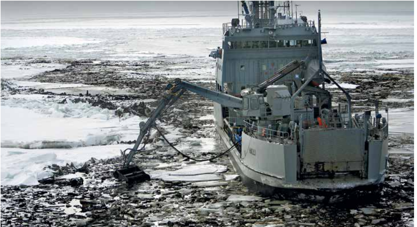
Kovalı Sıyrıcı (LRB 250), kapasite: 140 \text{ m}^3/\text{s} (616 galon/dakika)
