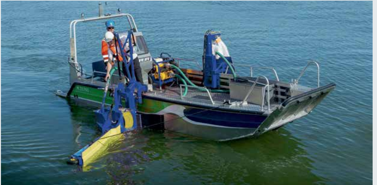
Borda Kolektörü / MiniBagger, kapasite: 10 m 3 /s (44 galon/dakika)
