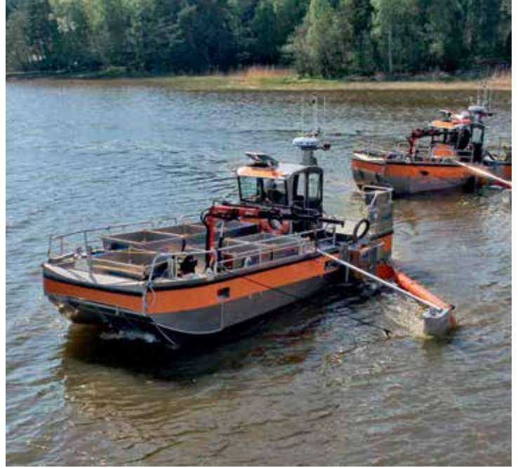
Olağanüstü Düşük Su Çekimli Hizmet Teknesi petrol toplamak amacıyla borda kutusuyla donatılmıştır
