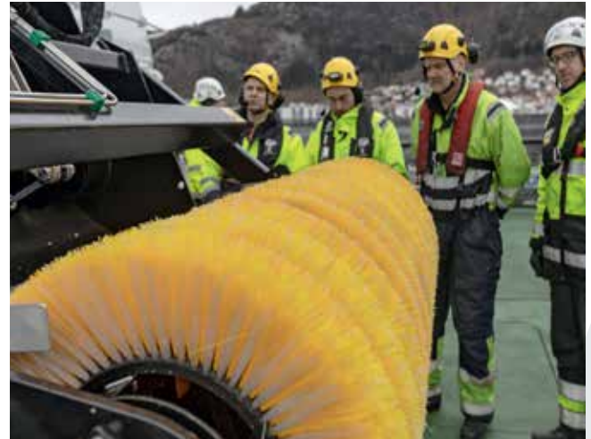
Tekneye Monte Kovalı Sıyırıcı (LRB 150), kapasite: 115 m 3 /s (506 galon/dakika)
