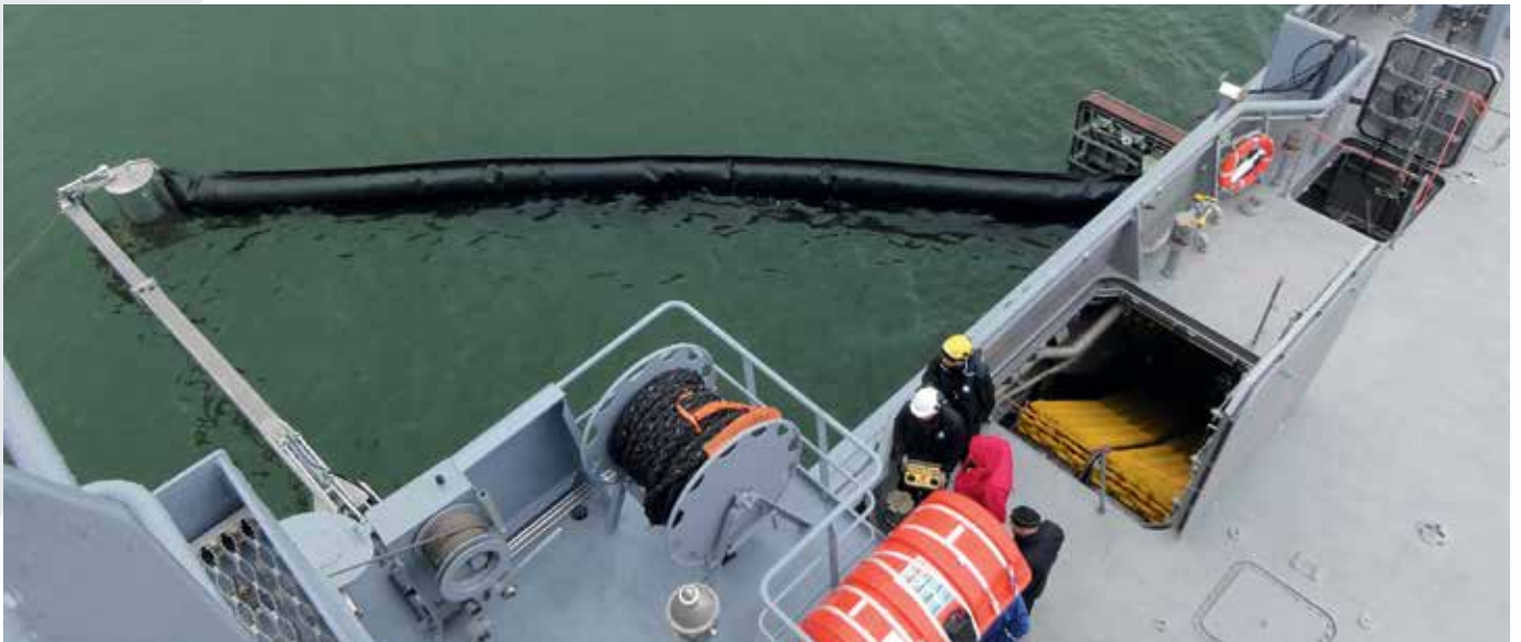
Yerleşik Petrol Toplama Sistemi (LORS)
