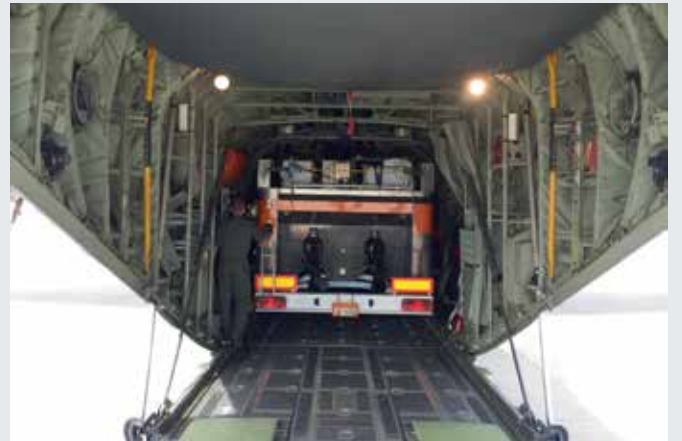
Hercules uçağına yüklenmiş Olağanüstü Düşük Su Çekimli Hizmet Teknesi
