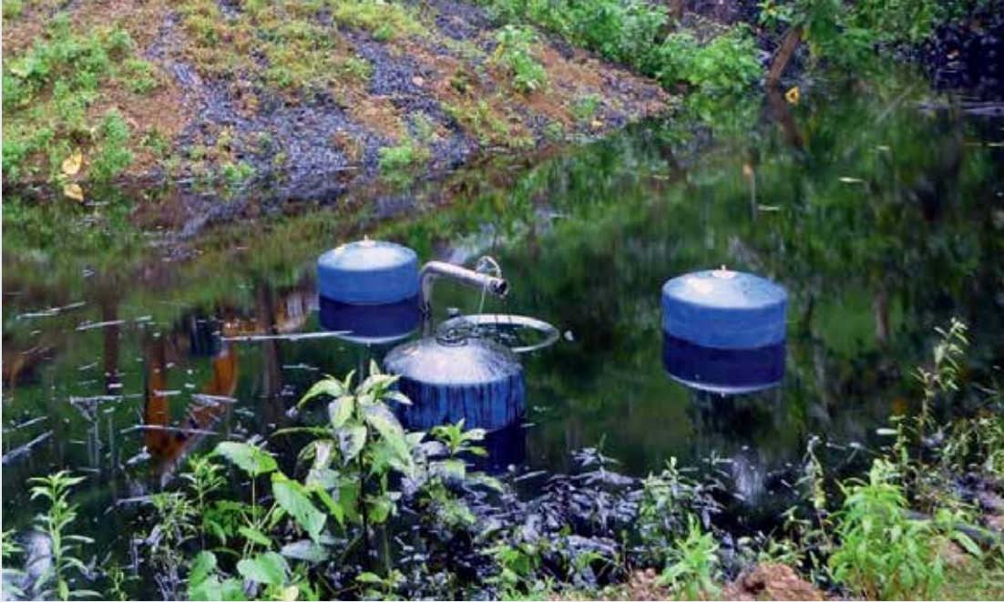
Bent sıyırıcı 500, kapasite: 70 m 3 /s (308 galon/dakika)
