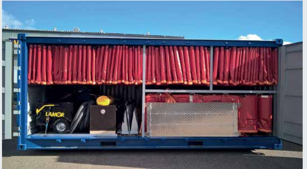
Köpük Doldurulmuş Bariyerler bir konterner içinde raflarda depolanır
