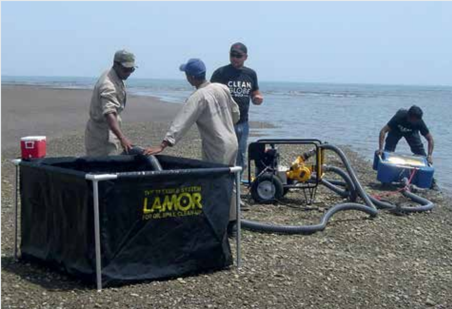
Katlanır petrol depolama tankı, LPP 6 C 75 ve Minimax 12 sıyrıcı
