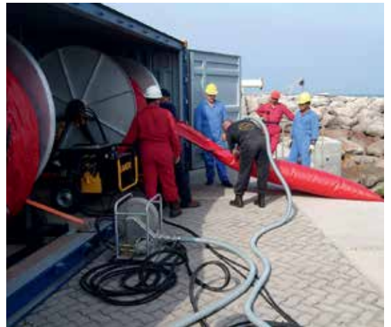
Şişme Hafif Bariyer (PVC/PU ve Neopren), yükseklik: 650-1650 mm (26-65 inç)
