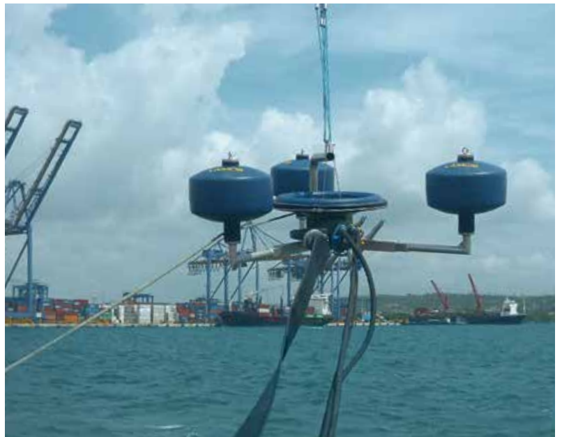
Bent Sıyırıcı 800 (LWS 800) kapasite: 112,2 m 3 /s (494 galon/dakika)
