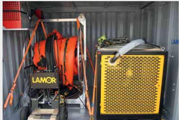
Sıyrıcılar için güç ünitesi, hortumlu tambur ve hidrolik kontrol seti içeren konteynerli çözüm
