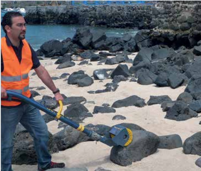
Kaya Temizleyici (LRC), kapasite: 9,7 m 3 /s (43 galon/dakika)
