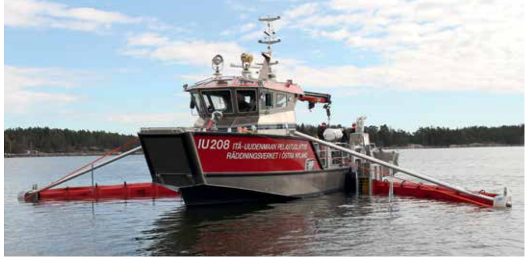
Borda Kutusu Toplama Sistemi (LSC)
