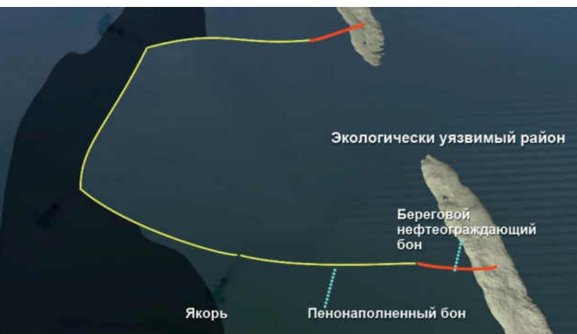
Десантный катер арктической баржи ЛАРН и защита бонами экологически уязвимых зон
