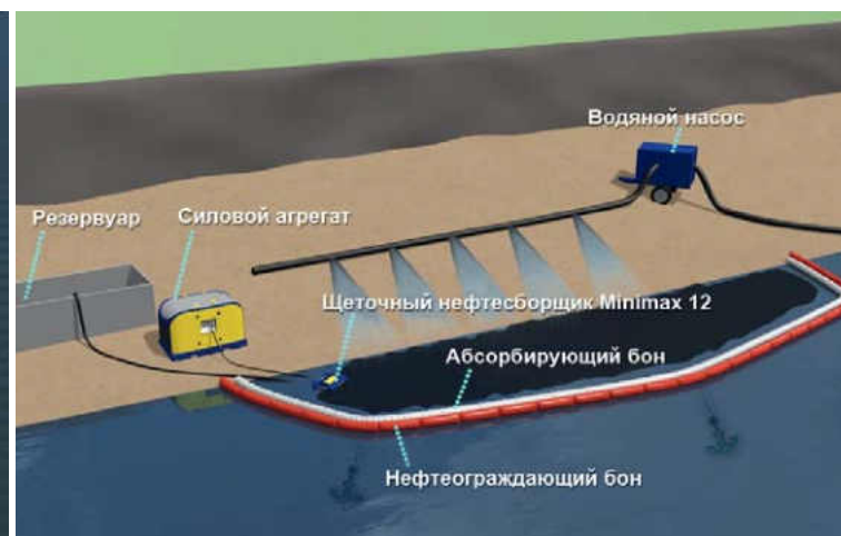
Бон для очистки береговой черты и оборудование для сбора нефти в арктических условиях
