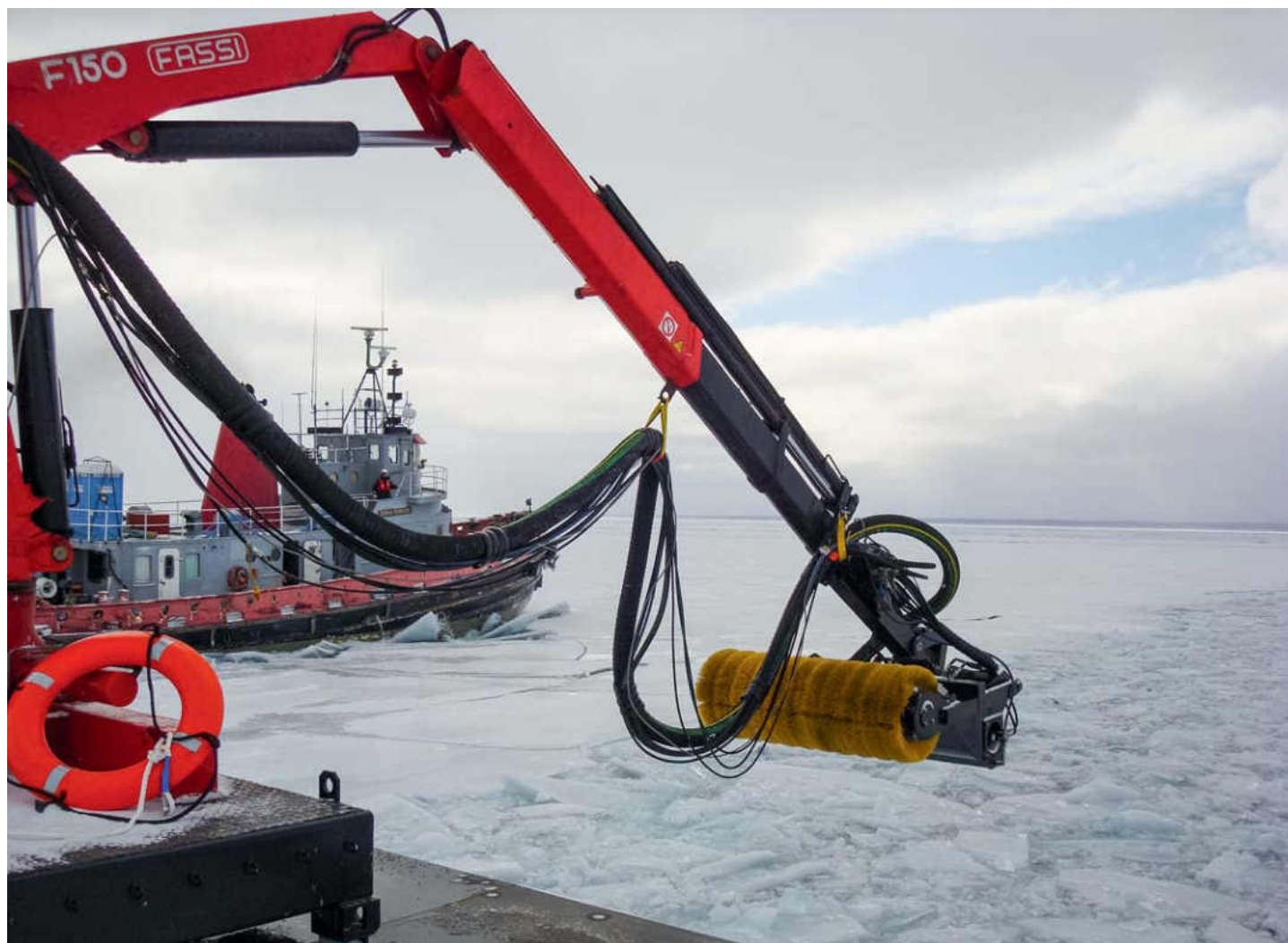
Ковшовый нефтесборщик Lamog (LRB) можно эффективно использовать с помощью судового крана или экскаватора.
