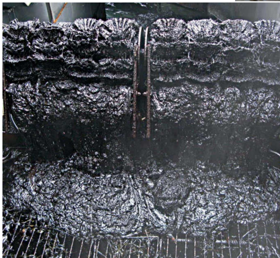
(внизу слева направо) Сбор вязкой нефти с использованием встроенной 8-щеточной конвейерной системы LORS Арктический нефтесборщик LAMOR
