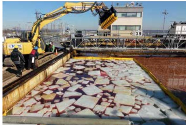
Skimmer de cubo (LRB 150), capacidad: 115 m<sup>3</sup>/h (506 gpm)
