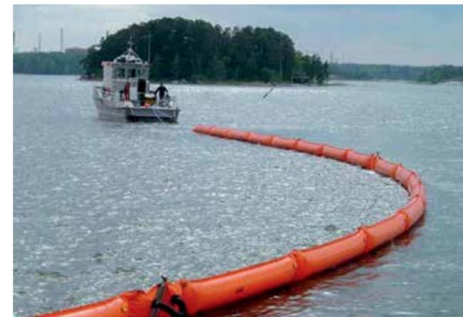
AutoBoom (PU y neopreno), altura: PU 550-1820 mm (22-60 pul.), Neopreno 970-2000 mm (38-79 pul.)
