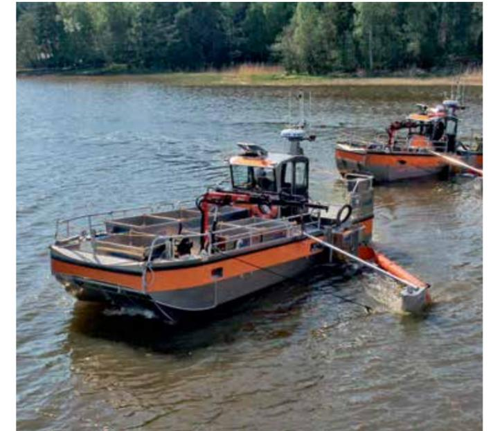
Embarcación de trabajo de calado ultrabajo equipada con contenedor lateral para la recuperación de petróleo
