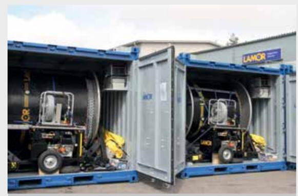
Solución con contenedores para barrera de contención de petróleo de alta resistencia HDB 1500
