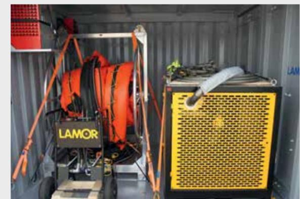
Solución con contenedores con unidad de potencia, carrito para manguera y conjunto de control hidráulico para los skimmers
