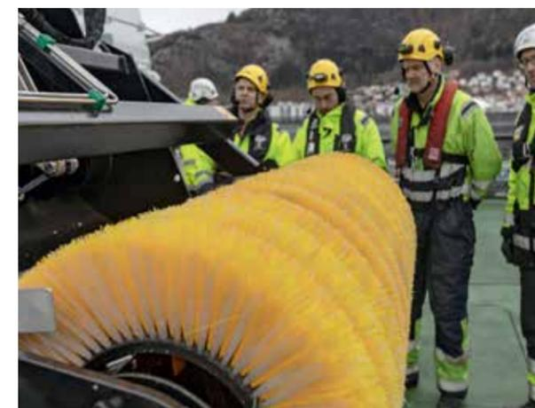
Skimmer de cubo montado en embarcación (LRB 150),
