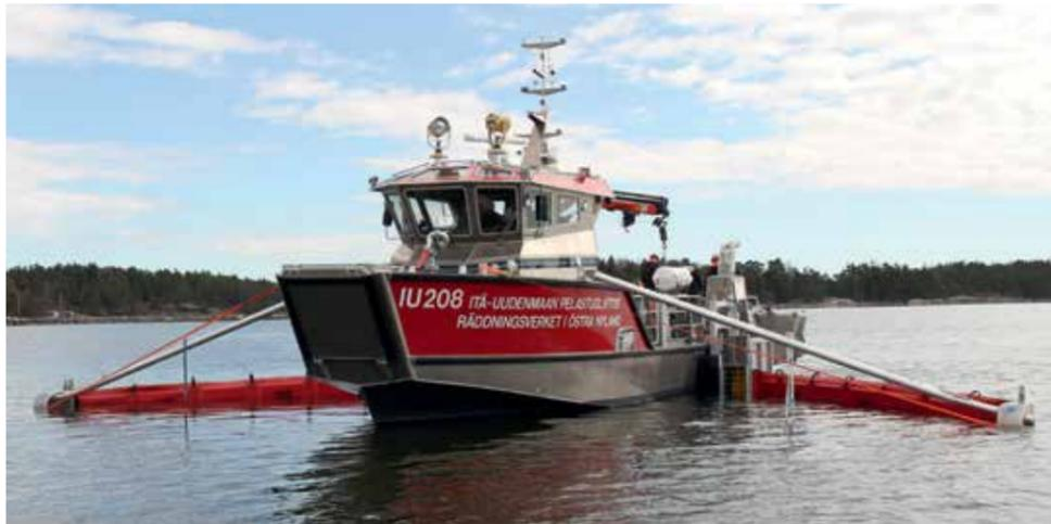
Sistema de recuperación mediante contenedor lateral (LSC)
