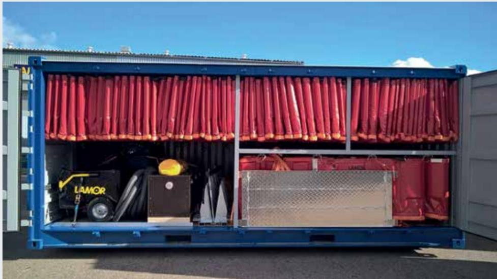
Barreras rellenas de espuma almacenadas en soportes, en un contenedor
