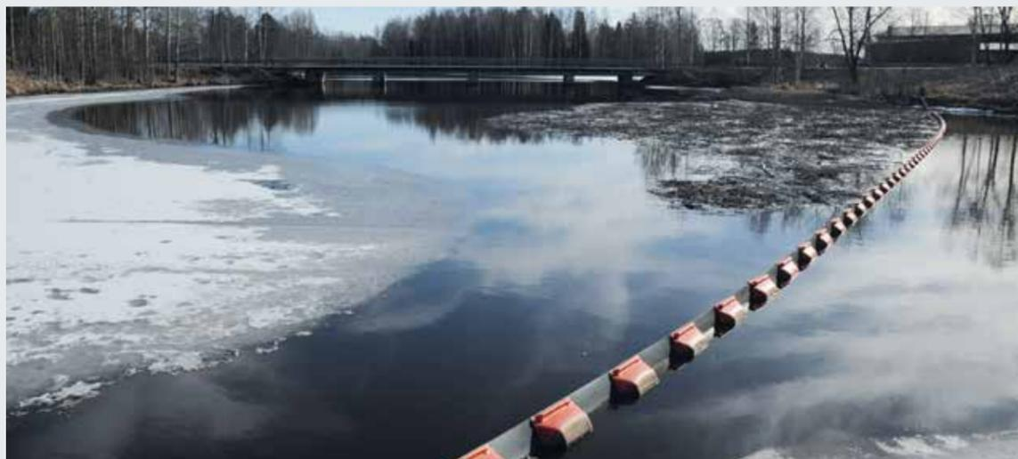
Barrera de contención permanente, altura: 460-910 mm (18-36 pul.)
