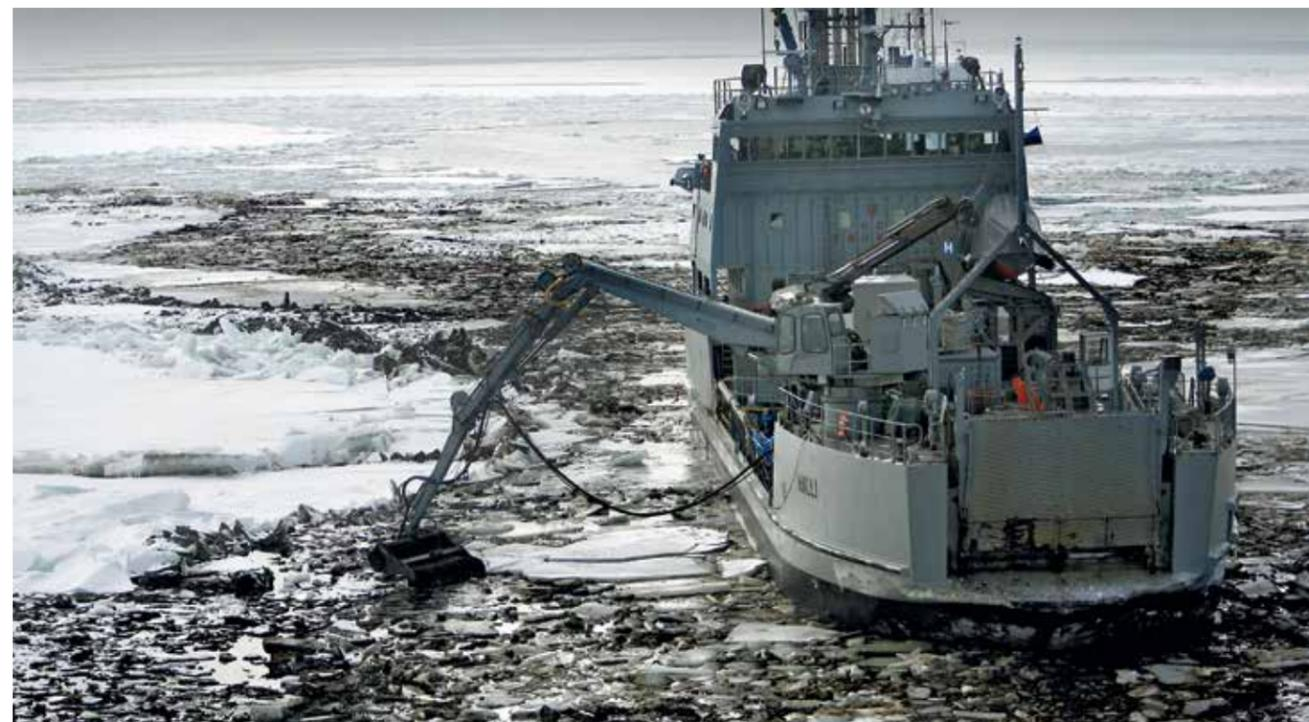
Skimmer de cubo (LRB 250), capacidad: 140 m<sup>3</sup>/h (616 gpm)
