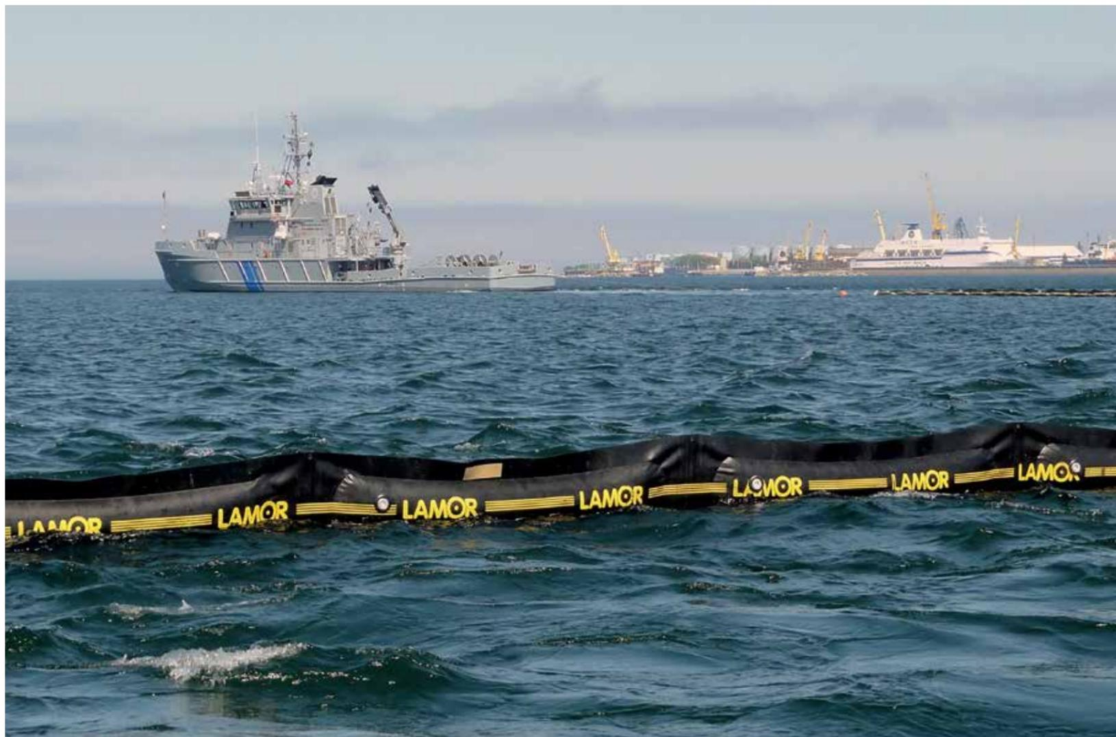
Barrera de contención de alta resistencia (caucho y neopreno), altura: 900-2000 mm (35-79 pul.)
