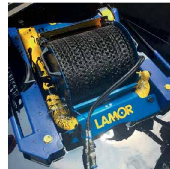
Minimax 25 (MM 25), capacidad: 25 m<sup>3</sup>/h (110 gpm)
