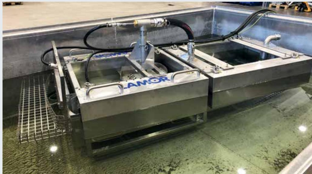
Skimmer con aire para procesos industriales (IPS A), capacidad: 9,7 m<sup>3</sup>/h (43 gpm)
