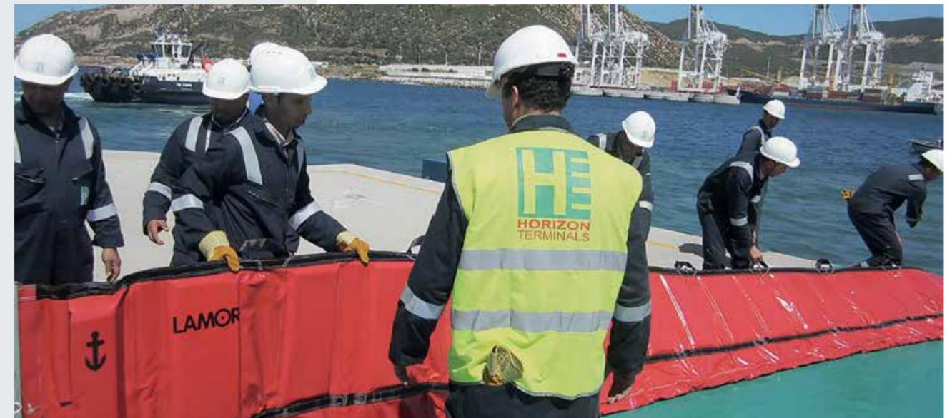
Barrera con relleno de espuma, altura: 350-1500 mm (14-59 pul.)
