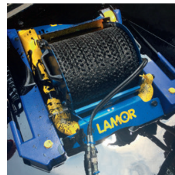
Mini max 25 (MM 25), capacity: 25 m 3 /h (110 gpm)
