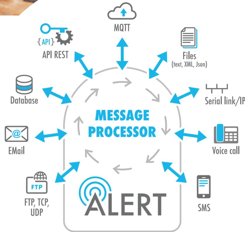
Le Processeur Message est un module d'interprétation de script temps-réel. Ces scripts, réalisés dans un langage de type BASIC offrent une multitude d'outils pour récupérer, traiter et diffuser de l'information.
