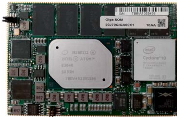
Das energieeffiziente CPU/FPGA-Board unterstützt zeitgesteuerte Berechnung, Netzwerkbetrieb und Echtzeit-IoT für zeitkritische Smart-Factory-Anwendungsfälle.
