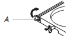
A. Bride de retenue du chariot e la bouteille
