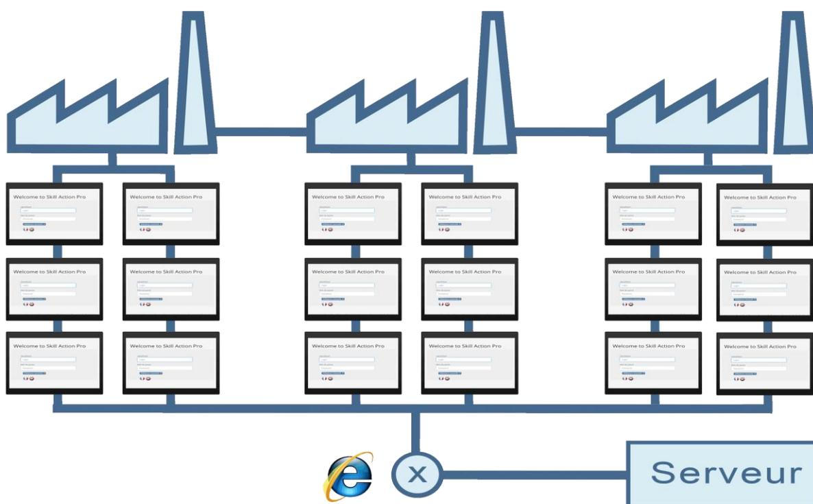
**CONFIGURATIONS** : Skill Action Pro un logiciel full web accessible depuis n'importe quel poste ayant une connexion internet. Le logiciel est soit installé chez le client soit hébergé par nos soins en mode SAAS. Les licences sont flottantes et correspondent à des "jetons" de connexions». Skill Action Pro est donc accessible 100% des postes, mais seulement X personnes se connectent en même temps. Demandez votre devis en ligne
