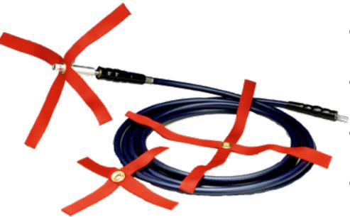
Le système DUCT-PRO® Power Whip de Abatement est un câble bidirectionnel de 20 pieds de long alimenté par une perceuse électrique standard 3/8" ou 1/2" (non incluse). Des fouets de type 'sangles' sont attachés à l'extrémité du Power Whip ce qui procure une agitation agressive à l'intérieur du système de conduits. Des brosses spécialement conçues pour les conduits peuvent remplacer les sangles pour offrir des options d'agitation supplémentaires.
