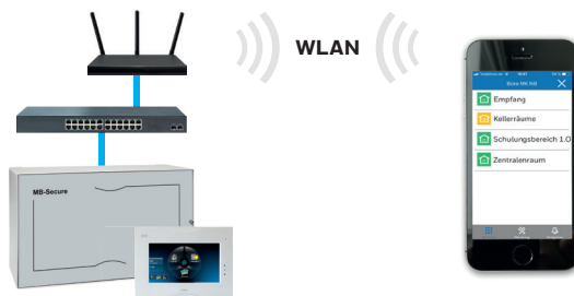
Verbindung im lokalen Netz per WLAN
