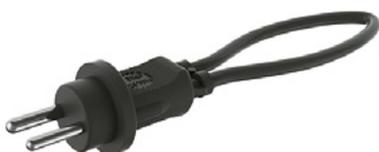
Este conector está diseñado para poner en cortocircuito el lado secundario de un transformador AGL que esté fuera de servicio, reduciendo prácticamente a cero el valor de la impedancia en su secundario. El conector también funciona como una tapa estanca.
