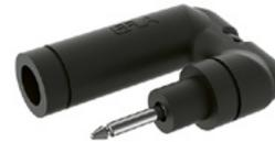
Resuelve el problema de hacer una instalación primaria sencilla en un espacio limitado permitiendo el ensamblaje del conector macho y hembra en un ángulo de 180°. La unidad cumple con L-823 estilos 2 y 9 de la FAA y cableado de 6mm<sup>2</sup>, 19 alambres trenzados, 5kV.
