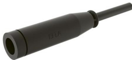
KDCP510和KDCR510将变压器连接到主电路。由于电缆的外护套和所有相关连接器都使用相同的热塑性弹性体 (TPE) 材料, 使得KDC初级导线保证助航灯光电路的最高可能介电强度。爱飞乐初级导线生产工艺符合FAA L-824 MIL-C-3432、ICEA S-66-524、MIL-C-4921规范。
