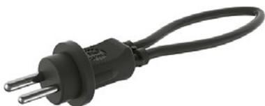
该连接器是为未被使用的助航灯光变压器的短路二次端设计的,几乎可消除二次端的阻抗。该连接器还可用作防水封盖。
