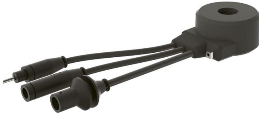
KR600系列将一次和二次电路分隔开，并为机场助航灯串联电路提供稳定的电流。KR600系列使用TPE材料注塑封装，其先进的环形设计保证了优秀的电器性能，同时具备十分重要的低漏感特性，可以更好地支持单灯监控和其他高级的监控系统。KR600是市场上最节能的隔离变压器。变压器通过了FAA和IEC的认证。同时也达到ICAO Annex 14和其他国际的标准，例如(MAK, CAAC)。
