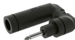
简单地解决了当一次端安装时空间狭小,使连接器的插头和插孔可以180度的角度连接。这个配件适用于FAA-L823型2和6mm<sup>2</sup>粗的线,19股,5KV。
