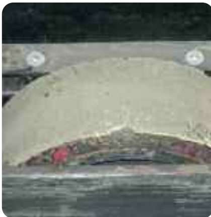
▶ Déformation thermique du filetage ou des flancs de pneu
