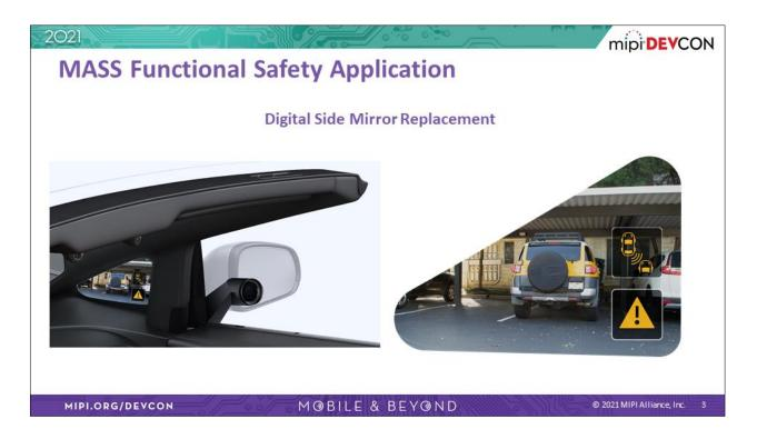
James Goel: 我们以汽车座舱的特定显示器为例,说明 MASS 如何让显示器得以支持更严格的功能安全目标。图中看到一个位置较低(low profile)、广角的汽车相机传感器,搭配嵌入式显示器,取代了传统的乘客座侧后视镜。改用数字后视镜之后,先进的光学系统减少了驾驶人的盲点,在夜间、低能见度、恶劣天气条件下也依然能发挥作用。它还具有额外的传感器功能,能侦测驾驶人可能看不到的物体和汽车。如图所示,汽车 ECU 分析了感测数据,并在屏幕上数字呈现了额外的安全标志和警告符号。这项应用中的车载显示器具有严格的安全目标,需要基于适当汽车危害分析的 ASIL D 认证。要能如此完整汇整,需要额外的像素信息,确保能符合 ISO26262 确立的ASIL D 定义。
