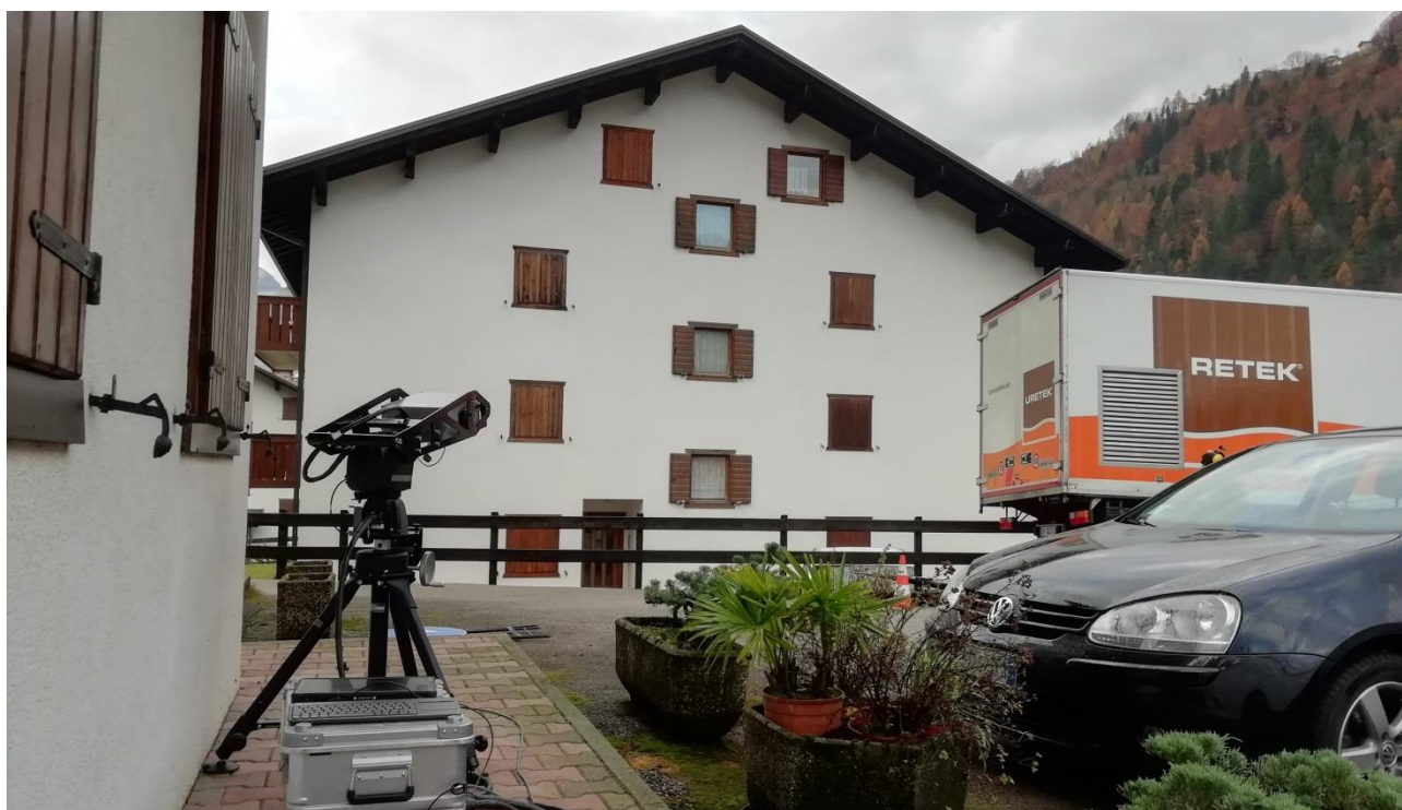
Figura 2-12: Posizionamento del radar per il monitoraggio della facciata Nord
