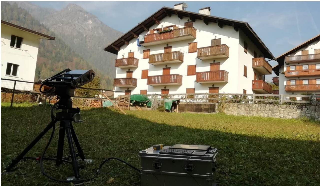
Figura 2-7: Posizionamento del radar per il monitoraggio della facciata Sud
