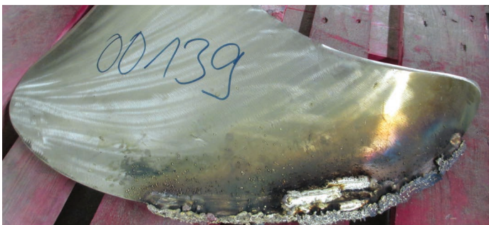
3: 焊接处理破坏部分
