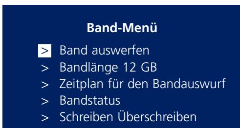
**Anmerkung:** Wenn das Band ausgeworfen wird und die Optionen für den Bandstatus 'grau' angezeigt werden, ist kein Band eingelegt.
